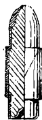
Proiettile del fucile svizzero Rubin Schmid N° 89 (Rivestimento-punta metallica coppo di caelici)
